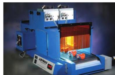
全ての Dymax コンベアーシステムは迅速で安全な硬化を提供する様に設計されている為非常に使い易く、紫外線を完全に遮断する事でユーザーは安全に使用する事ができます。ベルト輸送速度、調節可能なランプの高さ、安定したランプの照度は、安定し最適化された処理能力を提供します。
