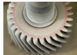
染色浸透探傷システム応用における欠陥表示結果
