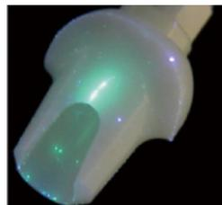
蛍光浸透探傷システム応用における欠陥表示結果
